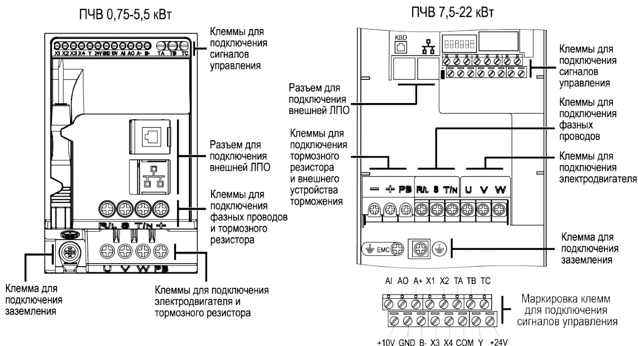
Рисунок 6.3 – Расположение клемм
